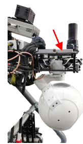
吊舱安装轨道
